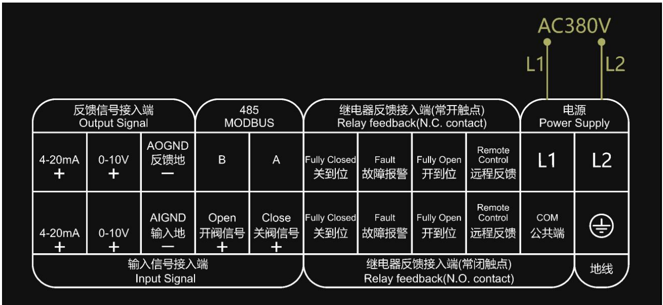
图 1 AC380V 电源接线方式
